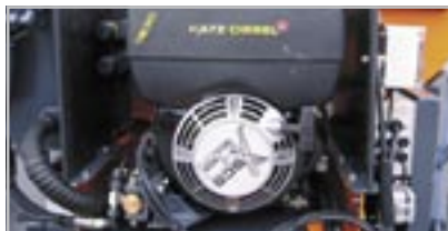
Der IGLOO Streuer ist mit einem Honda Benzinmotor (9,1 PS) oder einem Hatz Dieselmotor (6,6 PS) erhältlich. Der Vorteil eines Dieselmotors ist ein längerer Aktionsradius. Der Motor wird mittels der Fernbedienung gestartet.
